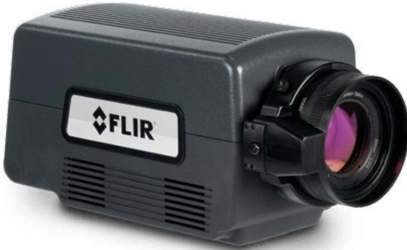
FLIR A8580 중파장 적외선(MWIR) 고해상도 열화상 카메라는 산업, 군사 및 제조 분야 연구개발 등에 사용될 수 있는 동급 최고의 이미지를 제공합니다. 1.3MP급 디텍터는 아름답고 선명한 이미지를 생성하며, 새롭게 탑재된 4점식 원 필터 휠은 최대 3,000°C의 온도를 손쉽게 측정해 내는 성능을 제공합니다. 표준 수동 초점 기능, 표준 현미경 렌즈 이외에도 원격 전동식 초점 렌즈도 옵션으로 선택할 수 있기 때문에 목표물을 측정하는 픽셀의 수를 최대화하고 초점을 최적화하여 크기나 거리에 관계없이 정확한 온도 값을 확보할 수 있습니다. 아울러, 카메라를 Gigabit 이더넷 또는 CoaXPress를 통해 단일 케이블로 컴퓨터에 연결하면 FLIR Research Studio 소프트웨어를 통해 카메라 제어, 데이터 수집까지 할 수 있기 때문에 사용자는 빠르게 데이터를 분석하고 이해할 수 있습니다.
